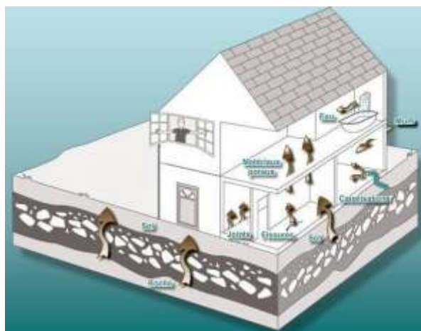
Fig 1. Voies d'entrée du radon dans un bâtiment.
